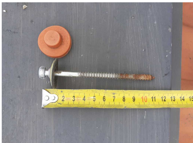
Foto /35/ Kotevní prvek střešní krytiny s ochrannou plastovou čepičkou
